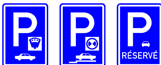
Vzorový vzhled instalovaného SDZ č. IP 13c, IP 13b, IP 12 (způsob stání musí odpovídat skutečné organizaci a orientaci vozidel a text, který bude obsahovat SDZ č. E 13, definují jednotlivé vzory pro vyplnění úsekových dodatkových tabulek).
